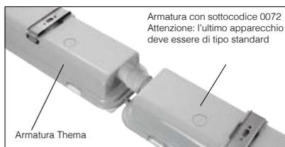
Fila continua con armatura speciale: per questo tipo di installazione è necessario che dal primo al penultimo apparecchio sia presente un cablaggio con linea passante e connettori tipo presa/spina (armatura a richiesta sottocodice -0072 con sovrapprezzo).
